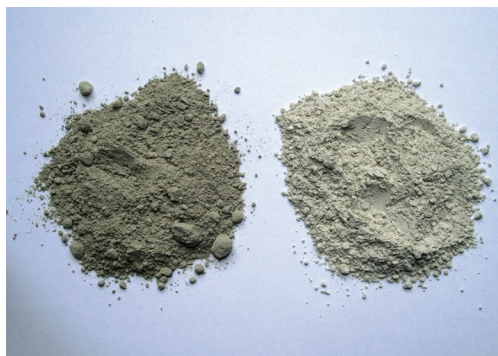
Tradycyjne ciemnoszare wapno z trassem HL 5 (po lewej) – oraz Optosan TrassKalk – widoczna różnica barwy.
