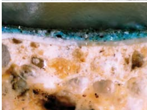
Przekrój próbki historycznej warstwy malarskiej ze sklepienia prezbiterium; na cienkiej pobiałej szarobłękitnej warstwie zawierającej duże kryształy azurytu i malachitu (fot. W. Grzesik)
