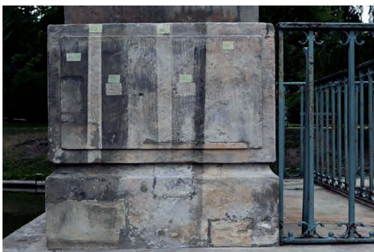
Powierzchnie próbne elementów kamiennych przygotowane do badań – oczyszczone metodami konwencjonalnymi oraz za pomocą promieniowania laserowego.
